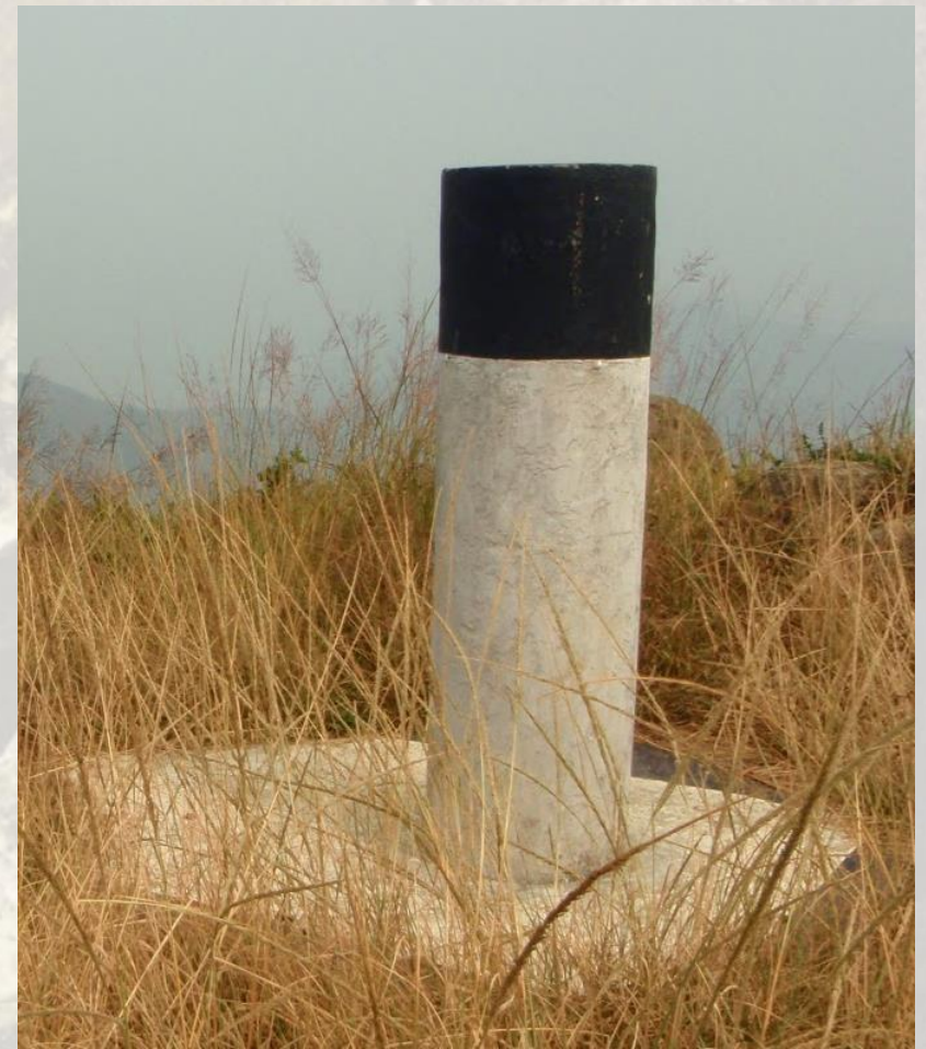
A trig point too – original 1843-45 style & 21 st century style 三角測量站 – 原先1843-45年及21世紀的式樣
